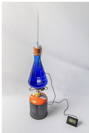
Obr. 5: Provedení pokusu „Teplotní roztažnost“.
